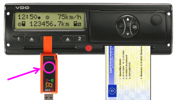
Bild 22: Einsatz TD zu Download Massenspeicher
