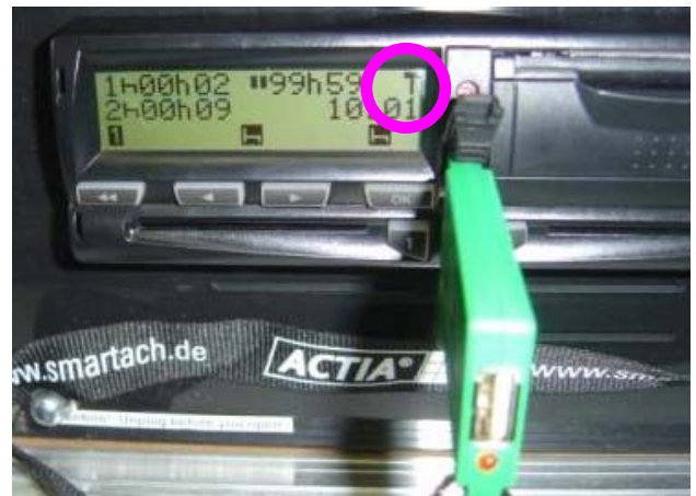
Bild 8: Tachograph im Kalibriermodus
